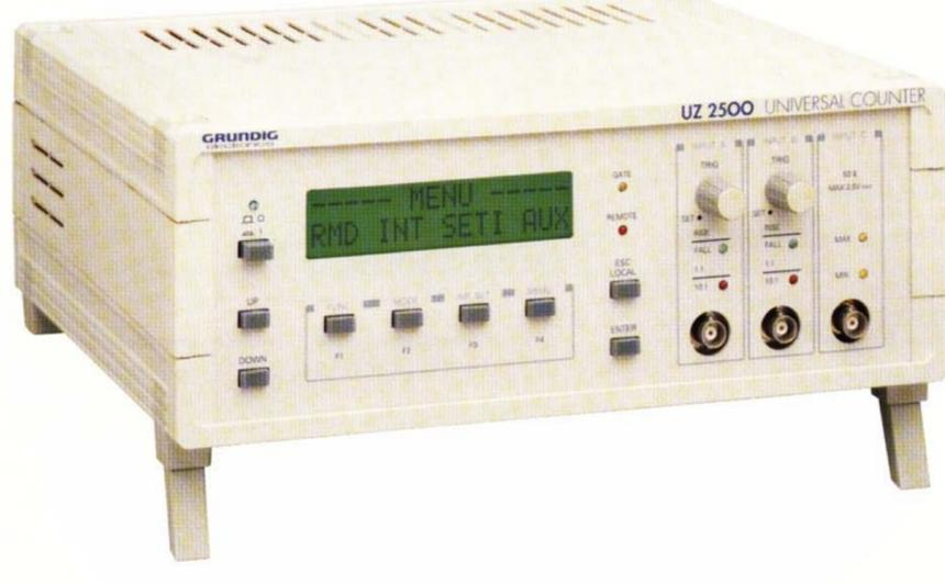
Mit dem Universalzähler UZ 2500 setzt GRUNDIG electronics die Reihe von völlig neu konzipierten Service-Meßgeräten fort. Wie alle anderen Meßgeräte dieser Reihe verfügt der UZ 2500 über ein modernes mikroprozessorunterstütztes Bedienkonzept. Die Bedienung erfolgt wie in dieser Baureihe üblich über ein LC-Display.
